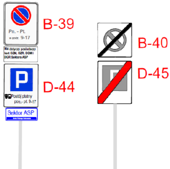
Rysunek 2. Oznakowanie pionowe na wjazdach (z lewej) oraz wyjazdach (z prawej) z strefy ASP
